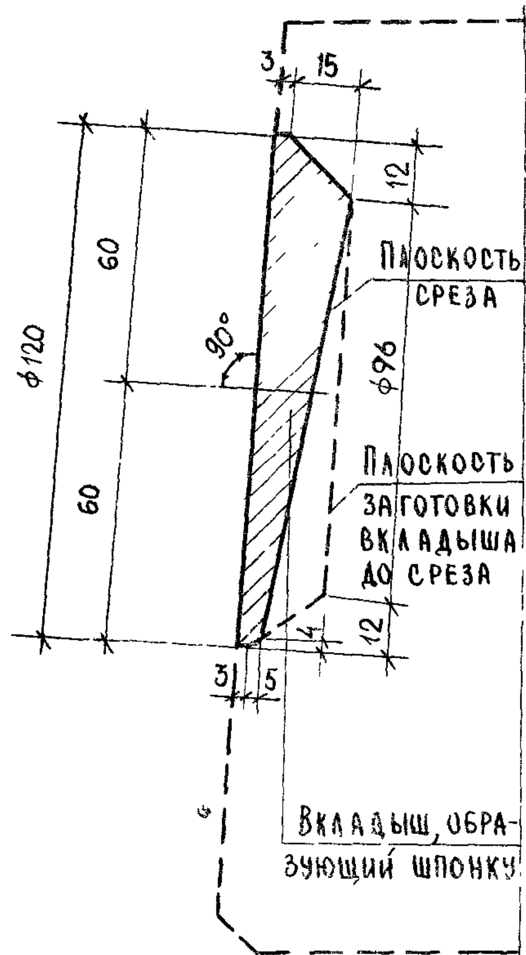
ДЕТАЛЬ ЗАГОТОВКИ ВКЛАДЫША, ОБРАЗУЮЩЕГО ШПОНКУ
